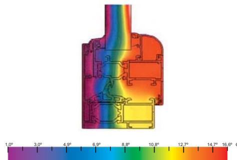
Ensayo según norma UNE-EN ISO 10077-2:2008
