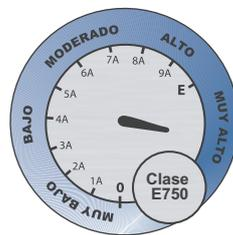
Ensayo según norma UNE-EN 1027:2000
