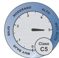
Ensayo según norma UNE-EN 12211:2000
